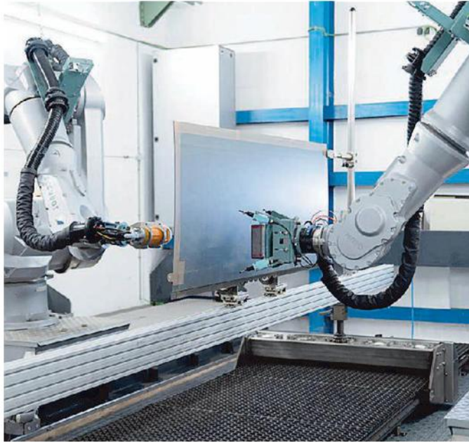
Il robot che si occuperà del controllo di qualità sugli aerei
